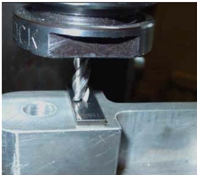
7.10. Ábra. Z eltolás meghatározása mérőhasáb érintésével marógépen
