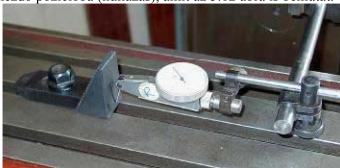
5.12. Ábra A nulla pozíció létrehozása
