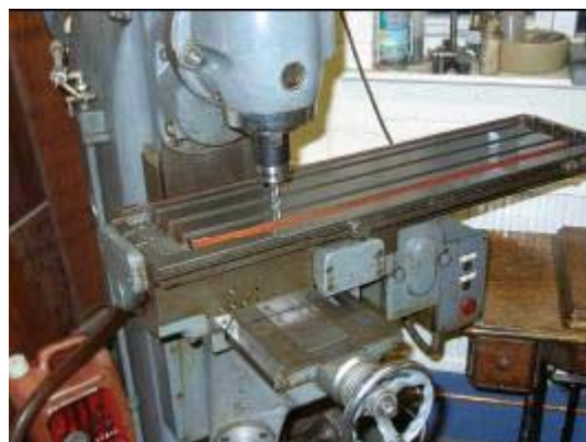
4.10. ábra Maró X=0, Y=0 pozícióban lévő szerszámmal
